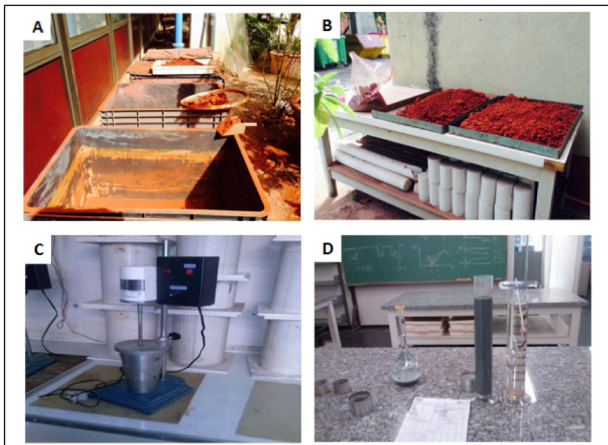
FIGURA 5.1-4 – Sequência de bancada dos ensaios de granulometria
