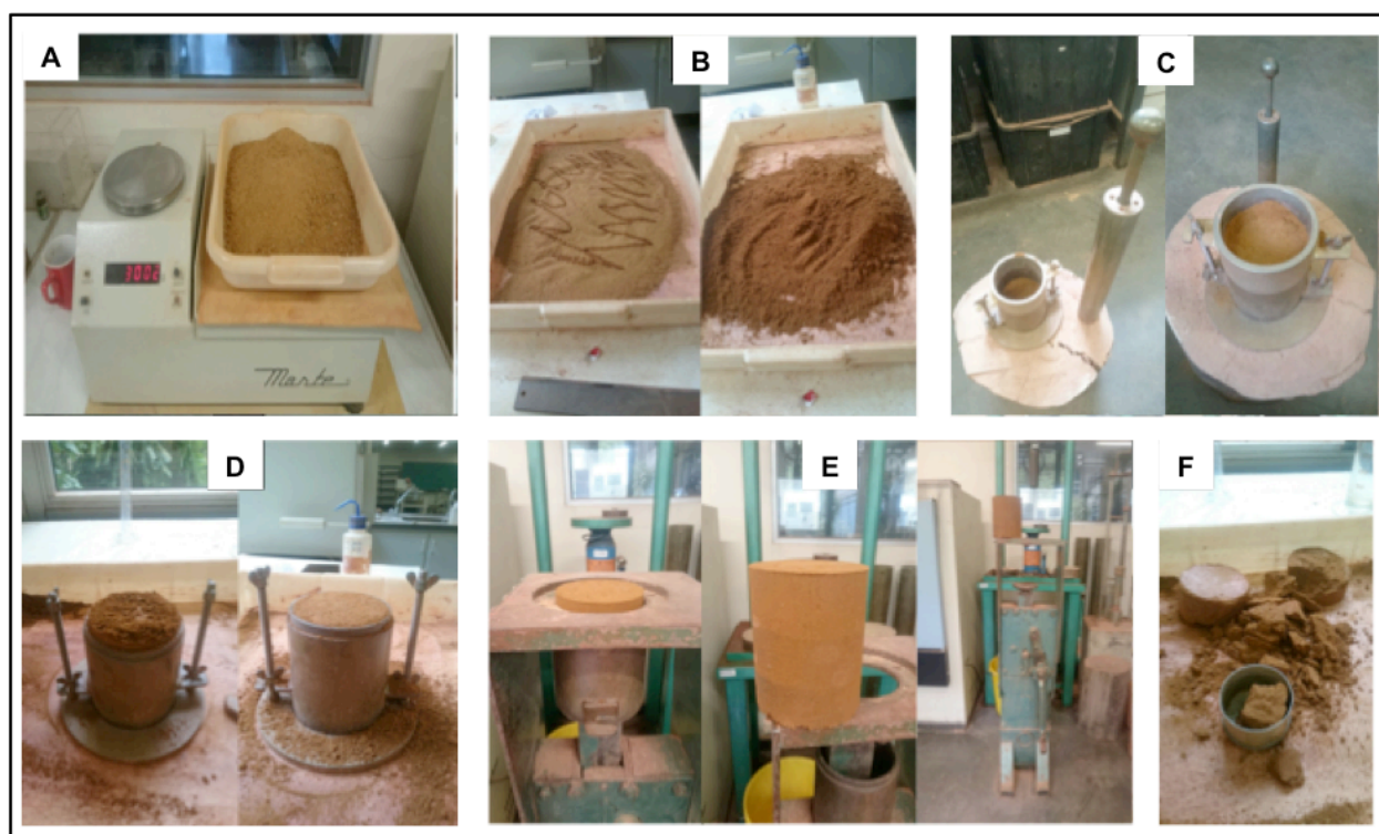
FIGURA 5.1-8 – Sequência de bancada dos ensaios de compactação de solo
