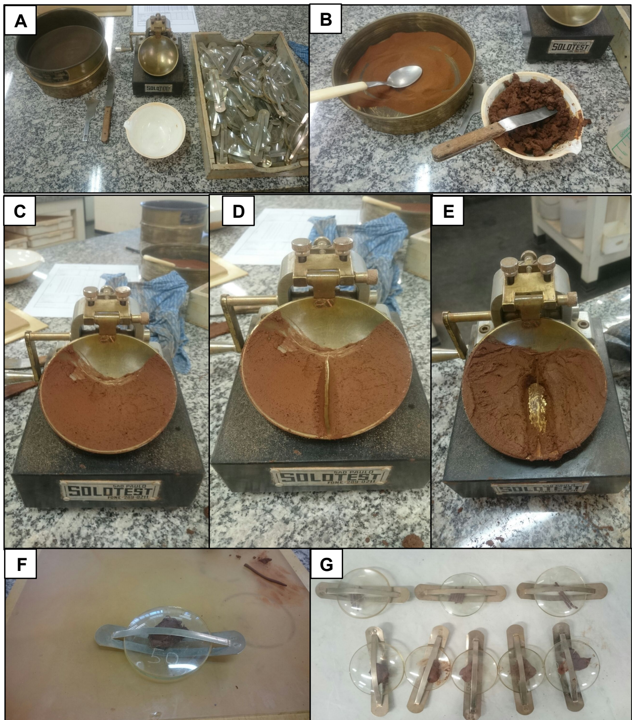
FIGURA 5.1-6 – Sequência de bancada dos ensaios de limites de liquidez e plasticidade
